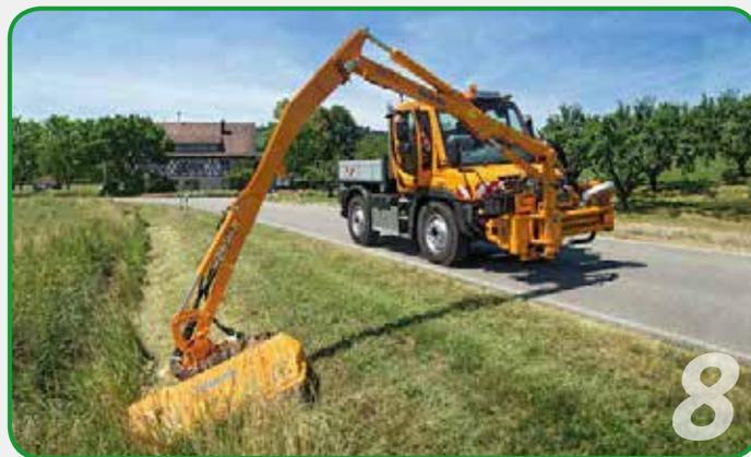
Unsere Frontauslegergeräte ermöglichen einen flexiblen Einsatz bis zu einer Reichweite von 7,4 m.
