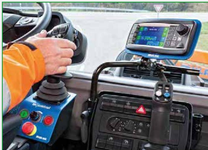
Der modulare Aufbau einzelner Steuerungskomponenten zum Einhandbedienteil, Kombinationsbedienteil oder Komfortsitzbedienteil bietet den Bedienern maximale Flexibilität. Die Steuerungselemente können für jedes Fahrzeug und Produkt individuell ausgewählt und angebracht werden. Damit ergeben sich optimale Lösungen für den professionellen Ein- und Zwei-Mann-Betrieb.
