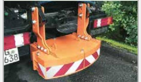
Das Ballastgewicht wird in die D50-Beschläge angebaut und wird modular zusammengestellt. Durch Ergänzung von Gewichtsplatten sind Gewichtsgruppen bis 1800 kg kombinierbar.
