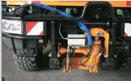
Vorderachsverriegelung des Unimog, um eine Fahrzeugverwindung (einseitige Einfederung) während des Mähbetriebs zu verhindern. Aktiviert wird die Blockierung über einen Kippschalter im Fahrerhaus.
