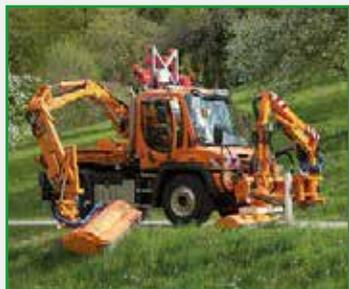
Das Produktprogramm umfasst Geräte mit und ohne automatische Aufnahme von Mähgut. Dabei ist mit Grasaufnahme eine Reichweite bis maximal 7,0 m, ohne Grasaufnahme sogar bis maximal 8,7 m möglich. Alle Gerätetypen können im Rechts- und Linksbetrieb eingesetzt werden.
