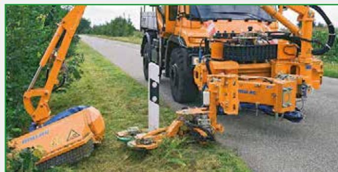
Leitpfostenausmäher im Wechselanbau am Kombinations-Mähgerät
