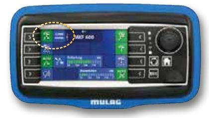
Mit Hilfe eines Sensors an der Messerwellenlagerung wird die aktuelle Messerwellendrehzahl erfasst und auf dem Bedienteil angezeigt. Bei Überschreitung eines Maximalwertes erfolgt eine Warnung.
