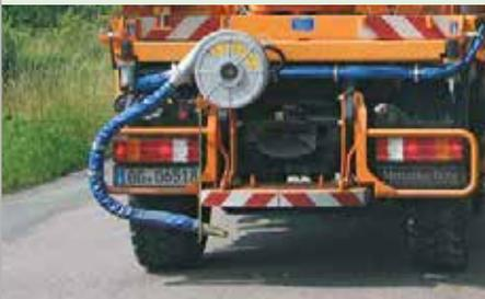
Angebaut in die D50-Anbaubeschläge dient das HDG zur effektiven Reinigung der Fahrbahn. Verunreinigungen werden wirkungsvoll an den Fahrbahnrand bzw. ins Bankett geblasen.
