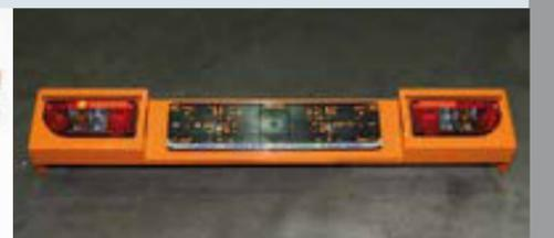
Lampenträger für Silostreuaufbau
