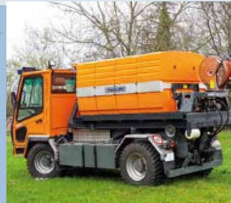
FTS 2700 mit Niederdruckanlage auf Abrollsystem
