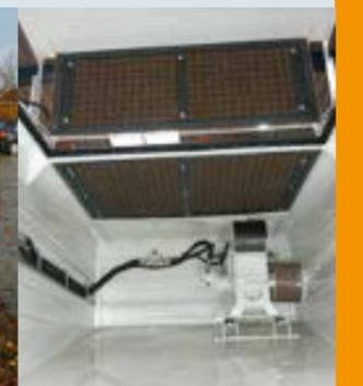
Über eine leistungsstarke Turbine und einen Handsaug- schlauch können alle schwer zugänglichen Stellen von Unrat und Laub befreit werden. Die Filterelemente können mit dem Wasser- schlauch oder mit dem Hochdruck- reiniger gesäubert werden.
