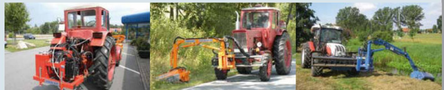
Powerpack mit Steuerblock und Bedienpult zum Antrieb und zur Bedienung eines Frontauslegers an Traktoren ohne Leistungshydraulik, Steuerhydraulik und ohne Frontzapfwelle
