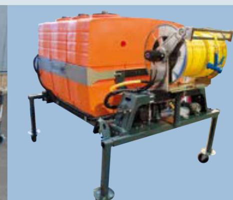
Niederdruckausführung mit hydraulischem Schlauchaufroller
