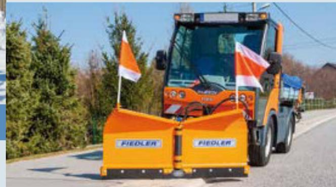
Über einen Hydraulikzylinder kann die Seitenneigung des Keilpfluges verstellt werden. Damit können auch schmale Fußwege geräumt werden, auf welche ein Fahrzeug mit seiner Fahrzeugbreite nicht passt.
