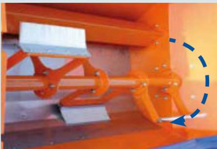
Eine Edelstahlwanne aus V4A schützt die Streuerwand vor Korrosion und Verschleiß.
