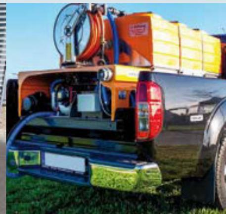
FTS 975 mit Benzinpumpe für Pick Up
