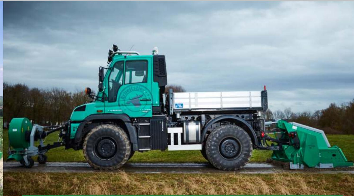
Ein Wasserfass mit elektrischer Förderpumpe und mit einer Sprühleiste vor dem Plattenverdichter PVH 240 bewässert die lose, planierte Verschleissdecke um mit dem über die Unimog Bordhydraulik angetriebenem Plattenverdichter direkt wieder zu verfestigen.
