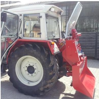
Alle MAXWALD-Seilwinden zeichnen sich durch geringes Eigengewicht und einen nahen Anbau am Trägerfahrzeug aus.
