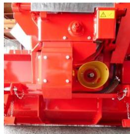
Bei Seilwinden mit elektro-hydraulischer Steuerung verwenden wir eine der Antriebswellen für den Antrieb der Hydraulikpumpe, d.h. langsamere Seilgeschwindigkeit ist bereits Serie!
