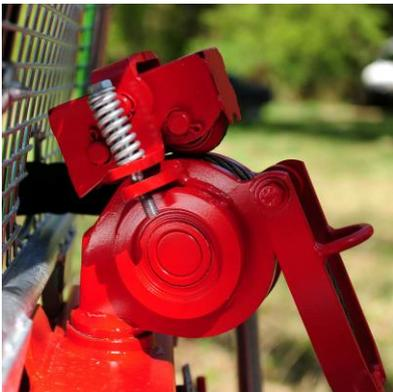
Die Seilspulvorrichtung ermöglicht auch den Einsatz einer sehr **breiten Trommel**. Dies hat zur Folge, dass der **Zugkraftverlust gering** ist (wenige Seillagen) und **viel Seil** auf die Trommel passt (bis zu 130m/11mm oder 160m/10mm).
