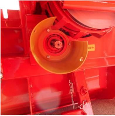
In der Praxis ist die Höhe des Antriebes und die zentrale **Position des Zapfwellenstummels** wichtig. Bei starkem Zuzug wird die Winde in den Boden hineingezogen. Sind der Antrieb, Bremse, Kupplung,... zu weit unten, verschmutzen diese dadurch schnell und werden unwirksam.
