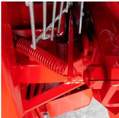
Weiters sind alle MAXWALD Seilwinden serienmäßig mit einer ebenfalls wartungsfreien und selbstjustierenden **Trommelnachlaufbremse** ausgerüstet.
