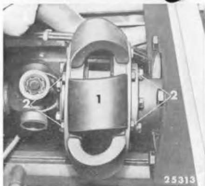
Elastische Kupplung für Nebenantrieb 1 Kreuzstollen 2 Befestigungsschrauben
